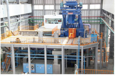
Vakum İndüksiyon Ergitme Fırını (VIM)
